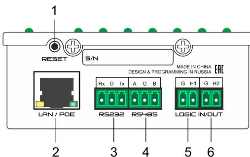
3 - разъем RS232 для подключения внешнего управляемого прибора
