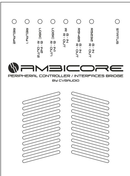
**STATUS** - двухцветный индикатор режима работы устройства. Моргание оранжево-красный / постоянное свечение зеленый - штатный режим работы. Частое моргание зеленым - режим загрузки новой прошивки (коротко зажать RESET на момент подачи питания). Частое моргание красным - режим очистки памяти и сброс к заводским настройкам (зажать и удерживать RESET на 4-5 секунд при включении электропитания)
